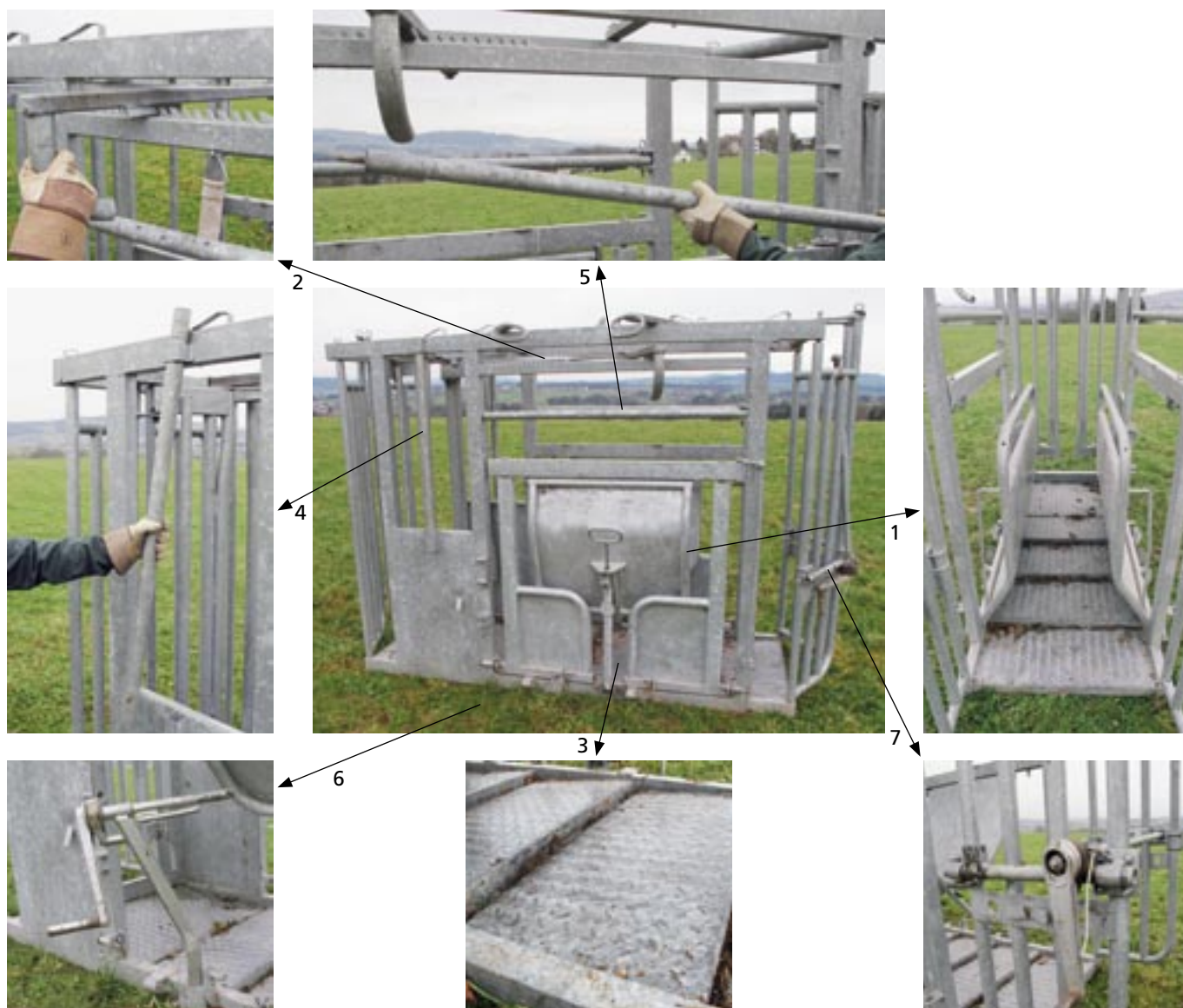
Abb. 10: Bei einem Behandlungsstand sollten die Breite des Standes eingestellt und die Tiere seitlich fixiert werden können sowie ein sicherer Zugang zu den Tieren gewährleistet sein: Verengungsbleche für Jungtiere (1), Arretierung für die Fixierung der Tiere (2), rutschfester Boden (3), vorderer Zugang zu den Tieren (4), seitlicher Zugang zu den Tieren (5), Fusswinde vorne mit lastunabhängiger Bremse (6), in zwei Positionen verstellbare Fusswinde hinten mit lastunabhängiger Bremse (7).
