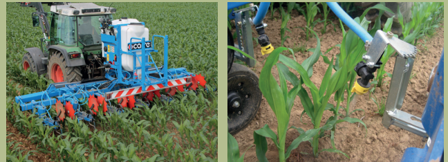
Abb. 2 : Kombiniertes System zum Spritzen in den Reihen und Hacken zwischen den Reihen
